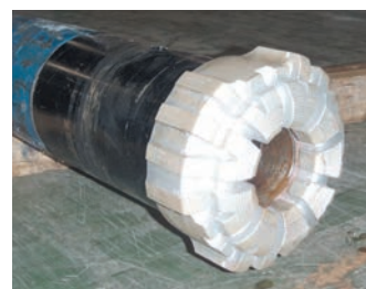
大深度用(8-1/2")PDCコアビットとセンタービット(上)と開発中の大深度超硬岩用インブリグネーティッドダイヤモンドコアビット(右)。
