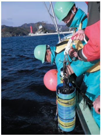
大槌湾内での係留系海洋環境モニタリング機器の設置の様子(左)。右はさまざまな観測機器をセットしたモニタリング機器。
