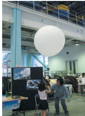
▲高層の気象を観測するラジオゾンデ。
