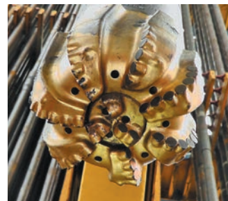
大深度用(8-1/2")PDCコアビットとセンタービット(上)と開発中の大深度超硬岩用インブリグネーティッドダイヤモンドコアビット(右)。
