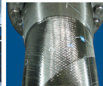
現在の鋼鉄製ライザーパイプ(左)と開発中の炭素繊維を使用したCFRPライザーパイプ(右)。
