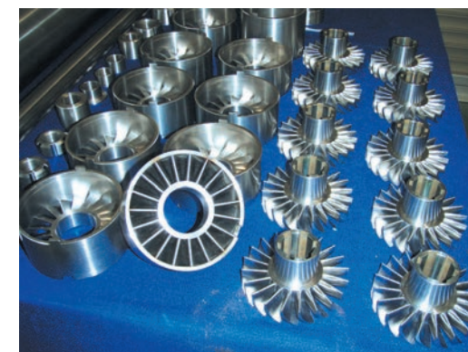
コアリングシステムに取り付ける泥水駆動タービンモーター(上)とタービンモーター構成翼(下)。
