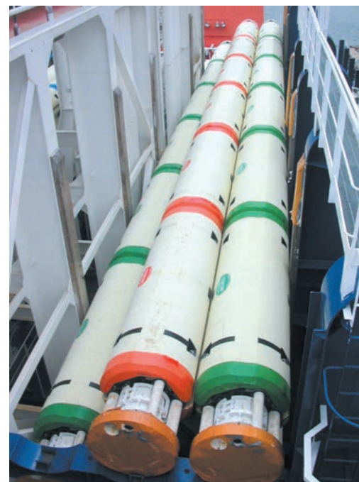
現在の鋼鉄製ライザーパイプ(左)と開発中の炭素繊維を使用したCFRPライザーパイプ(右)。
